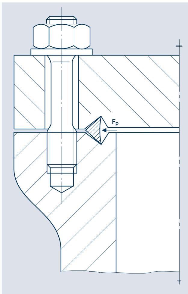
Aus dem Keilprofil ergibt sich eine hervorragende Anfangsdichtheit durch zum Teil plastische Verformung der sich gegenüberliegenden Spitzen der Dichtung beim Aufbringen der Schraubenvorspannkraft. Die radial selbstdichtende Wirkung tritt aufgrund des hohen Innendruckes durch elastisches Aufweiten der Dichtung ein.
