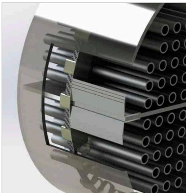
Die Lamellen der Trennblech-Dichtung Profil T4 sind mit dem Lamellenträger zu einer Lamelleneinheit punktverschweißt und in beliebigen Längen lieferbar. Aus Transportgründen sollten 6000 mm nicht überschritten werden. Wir liefern millimetergenaue Fixlängen nach Ihren Angaben, womit das schwierige Ablängen der dünnen Lamellen entfällt.
