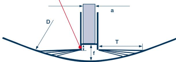
Durch die individuelle Festlegung des Maßes „s“ wird der Wirkungsgrad des Tauschers signifikant erhöht, und die Dichtung hat einen konstanten Anpressdruck.
