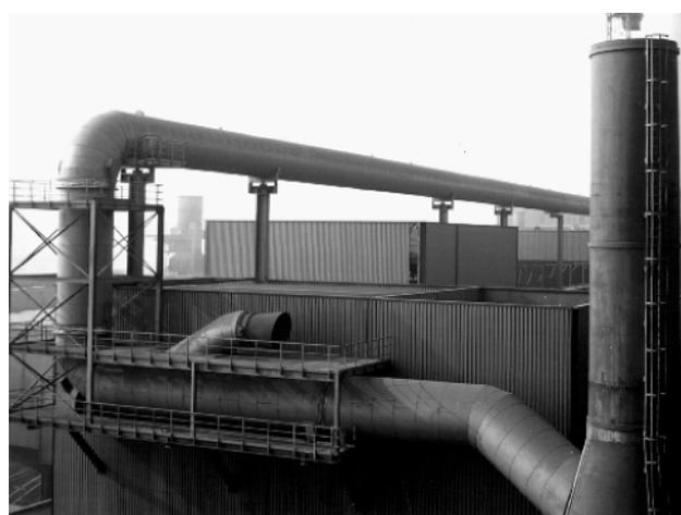
Kompensatoren am Anfang einer Wärmerückführung einer Sinteranlage
