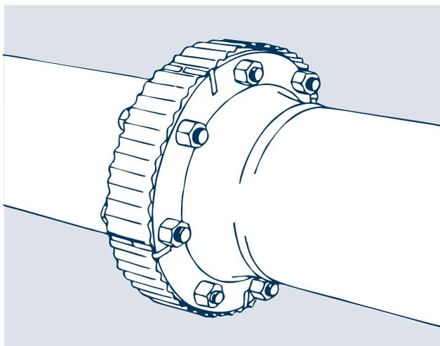
Das Austreten der gefährlichen Medien kann also in keinem Fall eine vor der Flanschverbindung stehende Person in einem direkten Strahl treffen. Vielmehr wird der Strahl einer Säure oder Lauge oder ein Wasserstrahl das Spritzschutzband innen beaufschlagen und dann entspannt durch die Öffnung abfließen.
