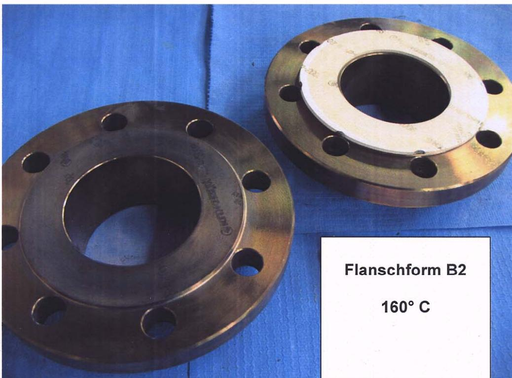
Bild 8: Übersichtsaufnahme der Dichtung KLINGER® top-chem 2006 (bedruckte Seite)
