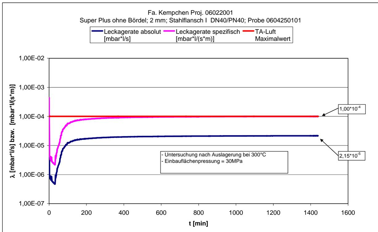
Probe 0604250101; Leckageuntersuchung bei 1 bar Prüfdruck
