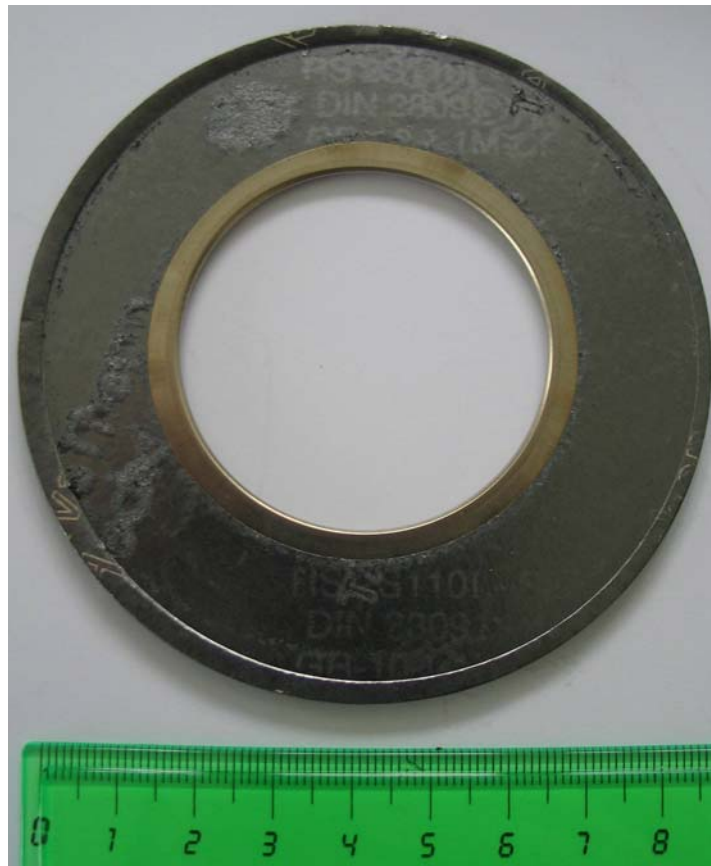
Probe 0605050201; RHD 2S350-I Rivatherm Hochdruck mit Innenbördel
