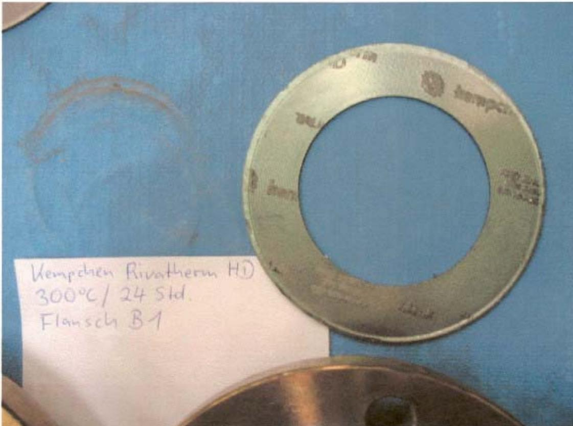
Bild 2: Dichtung aus Flansch B1
