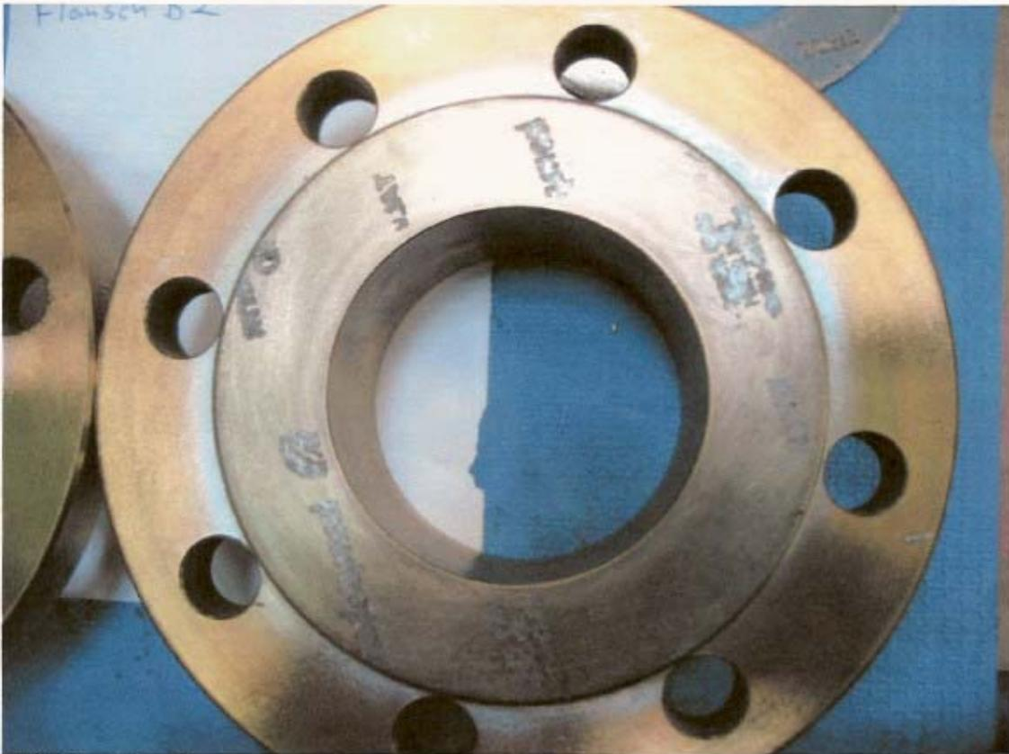
Bild 3: Flanschform B2
