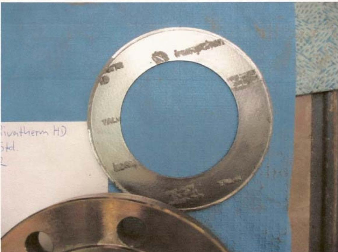
Bild 4: Dichtung aus Flansch B2
